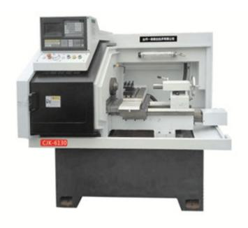
使用数控机床时,要定期更换存储器用电池;数控系统长期不用时的维护,经常给数控系统通电或使数控机床运行温机程序;备用电路板的维护机械部件的维护。对于数控机床中机械部件的维护,主要就是刀库及换刀机械手的维护。用手动方式往刀库上装刀时,要保证装到位,检查刀座上的锁紧是否可靠;严禁把超重、超长的刀具装入刀库,防止机械手换刀时掉刀或刀具与工件、夹具等发生碰撞;采用顺序选刀方式须注意刀具放置在刀库上的顺序是否正确。其他选刀方式也要注意所换刀具号是否与所需刀具一致,防止换错刀具导致事故发生;注意保持刀具刀柄和刀套的清洁;经常检查刀库的回零位置是否正确,检查机床主轴回换刀点位置是否到位,并及时调整,否则不能完成换刀动作。
